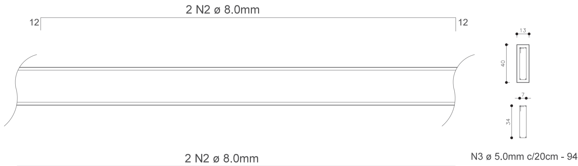
DETALHE VIGAS -13X40 ESCALA 1:25
